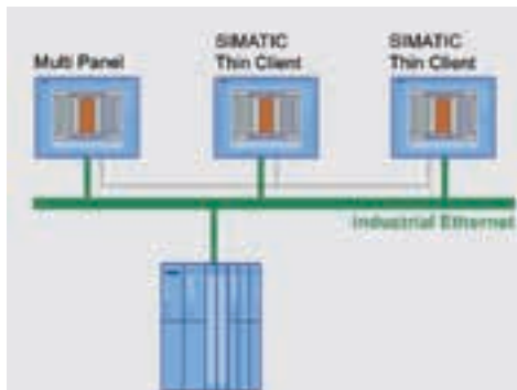
Thin Client'tan Sm@rtServer Operatör Paneline bağlantı
